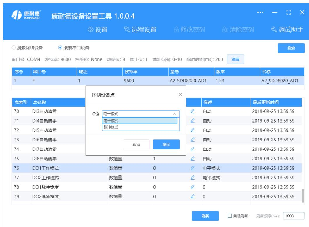
当DO为电平输出时，例如：如点击**DO1状态**点值后图标，写1时DO1指示灯点亮。写0时DO1指示灯熄灭。
