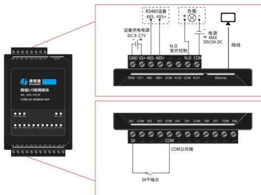
设备上电后，电源指示灯PWR红色常亮，运行指示灯RUN闪烁，设备供电正常。设备接上网线，网线另外一端插入电脑网口，网络指示灯SPD常亮、LINK闪烁，设备已接入网络。
