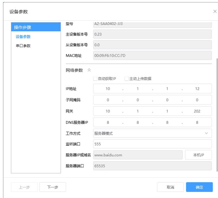
**自动获取IP：**如果勾选“自动获得 IP 地址”，那么此 C2000 所在网段当中的 DHCP 服务器将为其自动分配 IP 地址，但仍需手动设置上本网段默认网关；如不勾选“自动获得IP地址”需要手动为其指定IP地址和子网掩码、默认网关。
