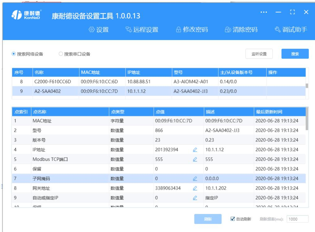
“设置”：用于设置网络型IO设备的网络参数或RS485型IO设备串口参数；
