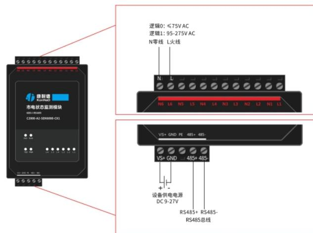
设备上电后，电源指示灯PWR红色常亮，运行指示灯RUN闪烁，设备供电正常。
