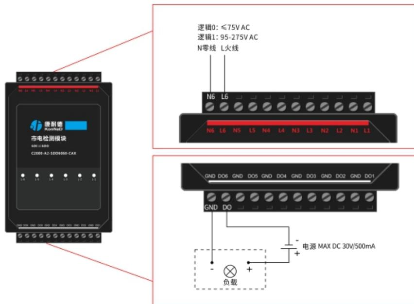
市电输入接线测试：在L1和N1接上220V 市电，可看到设备上L-1指示灯亮，断开灯灭。其它通道按照相同方法测试。
