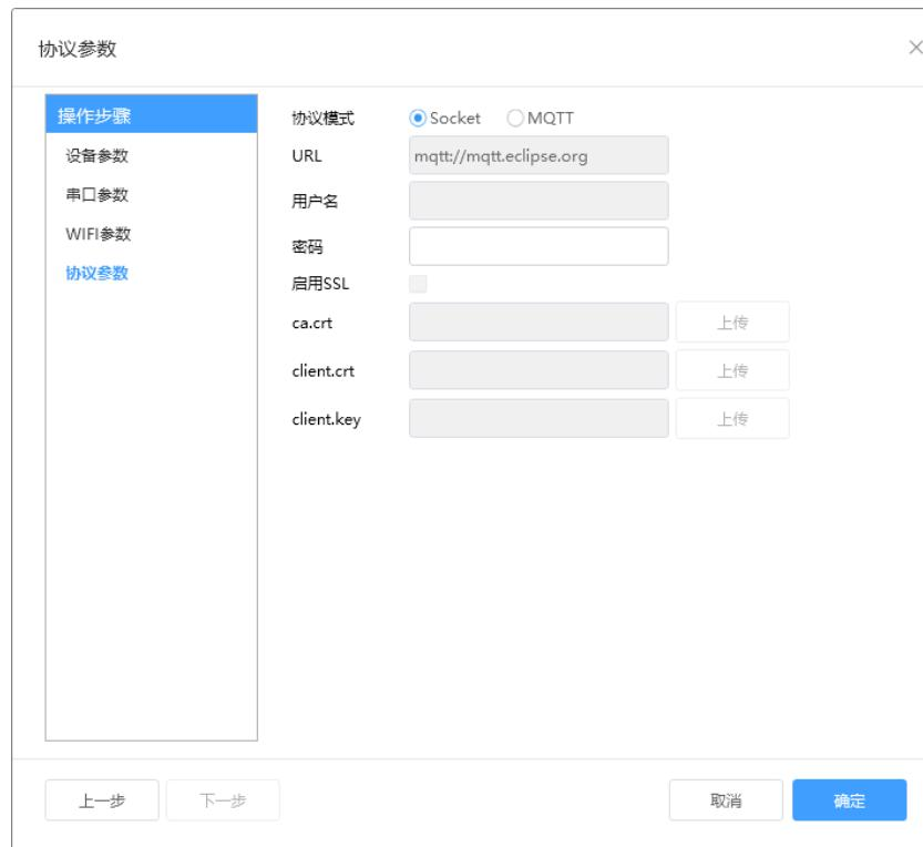
Socket : 设置后4G、wifi以TCP连接通讯，可以使用modbus协议读取，或者透传模式
