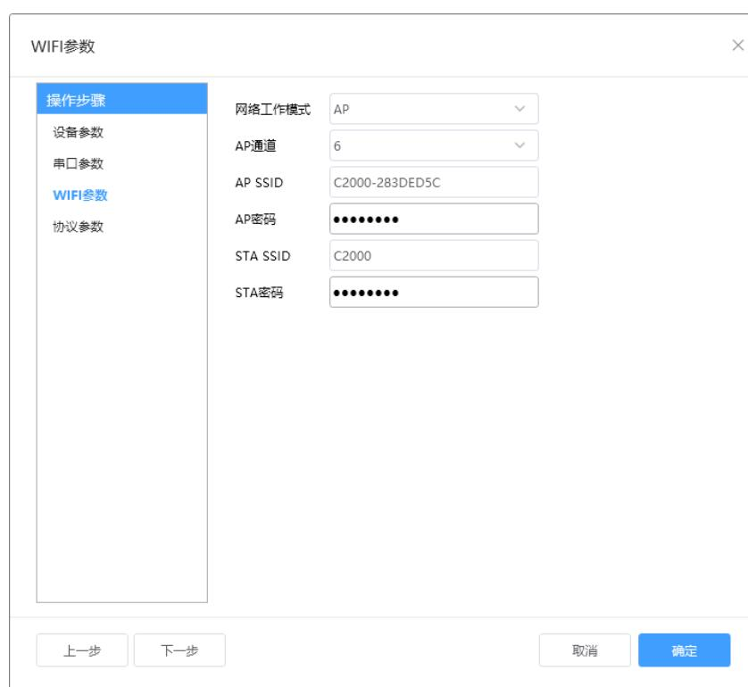
**网络工作模式**：可以选择AP或STA模式。除这里可以设置外，轻按 AP/STA 按键也可以实现模式的选择。（AP：即无线接入点，是一个无线网络的中心节点。通常使用的无线路由器就是一个AP，其它无线终端可以通过AP相互连接，产品在首次配置时需要使用此种方式；
